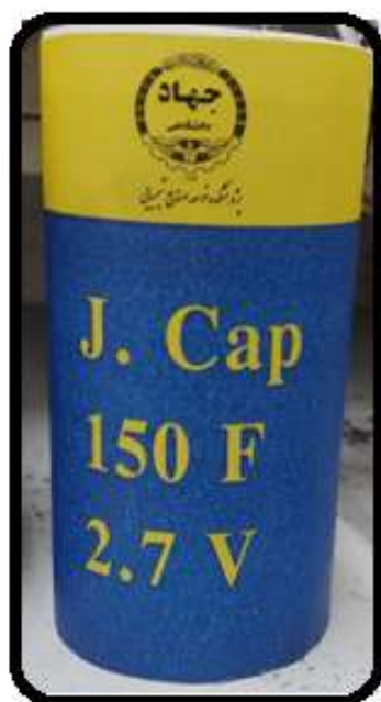
شکل ۵-۲۰ تصویر نمونه ابر خازن ساخته شده با ظرفیت ۵۰ فاراد
