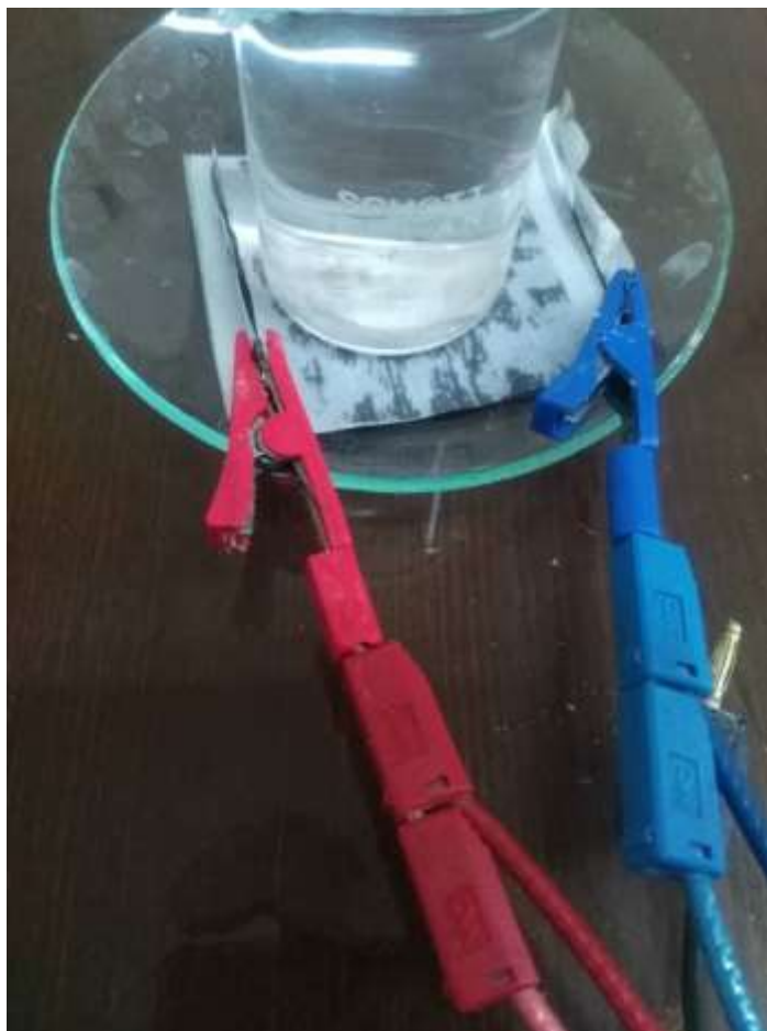
شکل ۵-۴ تصویر سیستم دو الکتروودی با سطح 4 \times 4 \text{ cm}
