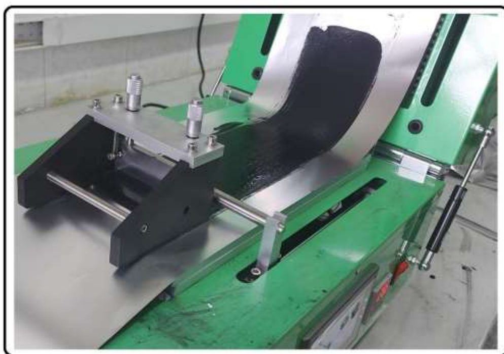
شکل ۵-۱۹ تصویر پوشش دهی متوالی فویل آلومینیوم در چند مرحله
