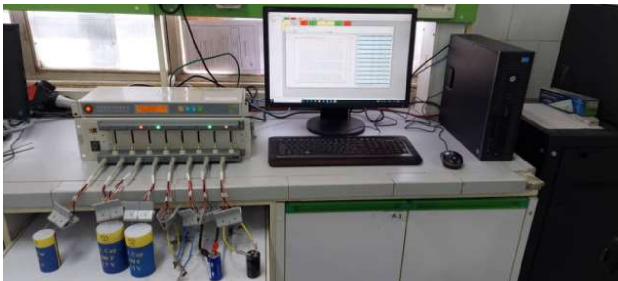
شکل ۵-۱۱ دستگاه اندازه گیری شارژ/ دشارژ نمونه های ابرخازن
