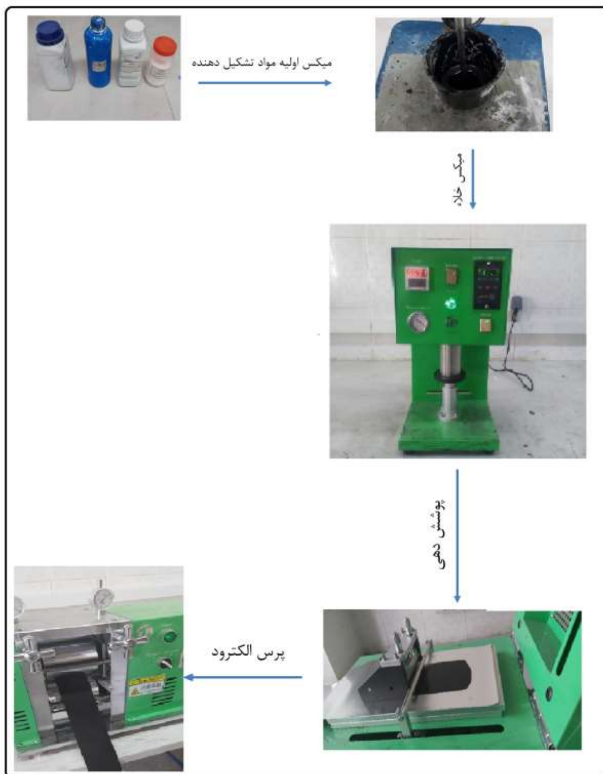
شکل ۵-۵ تصویر مراحل ساخت یک الکتروکروم ابرخازن
