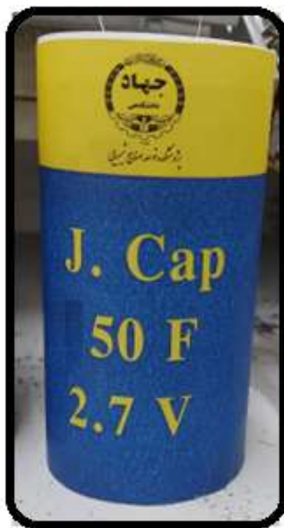
شکل ۵-۱۶ تصویر نمونه ابر خازن ساخته شده با ظرفیت ۵۰ فاراد
