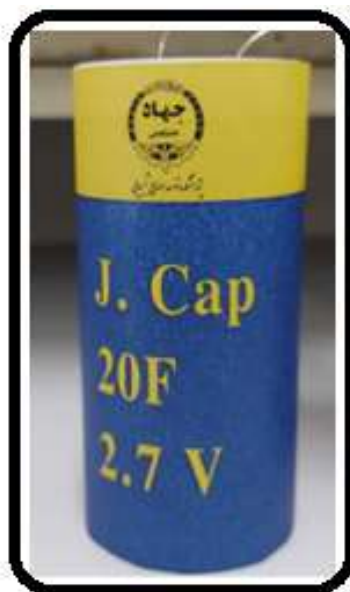
شکل ۵-۱۰ تصویر نمونه ابر خازن ساخته شده با ظرفیت ۲۰ فاراد
