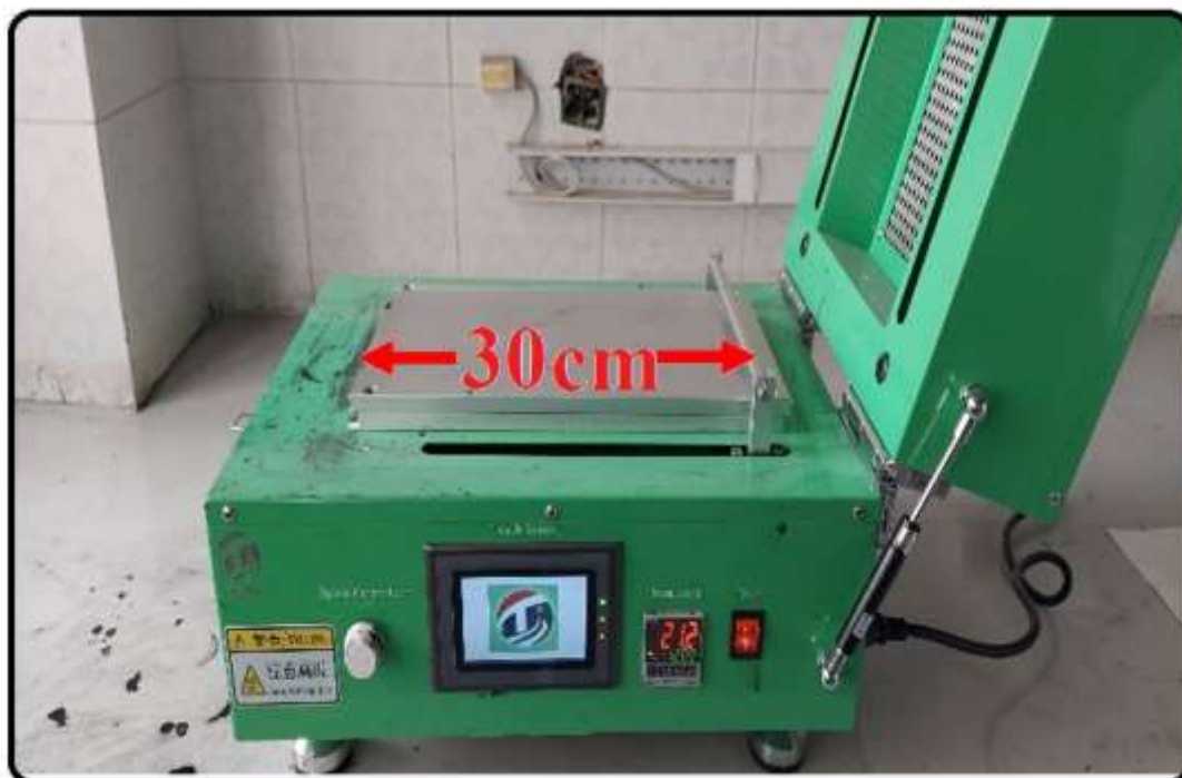
شکل ۵-۱۸ اندازه سطح دستگاه پوشش دهی الکترو
