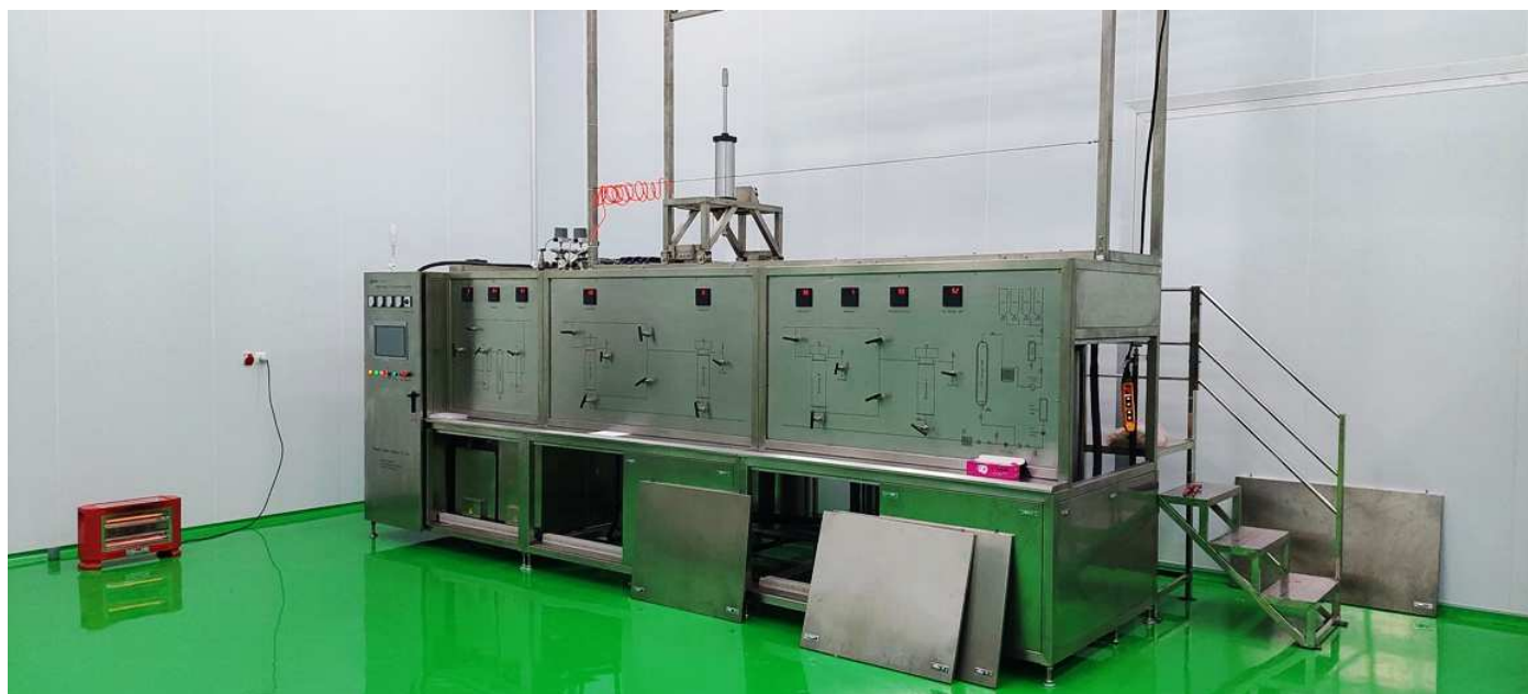
شکل ۱۴- دستگاه سیال فوق بحرانی شرکت گلفام دارو ارومیه با ظرفیت مناسب جهت انجام طرح پایلوت
