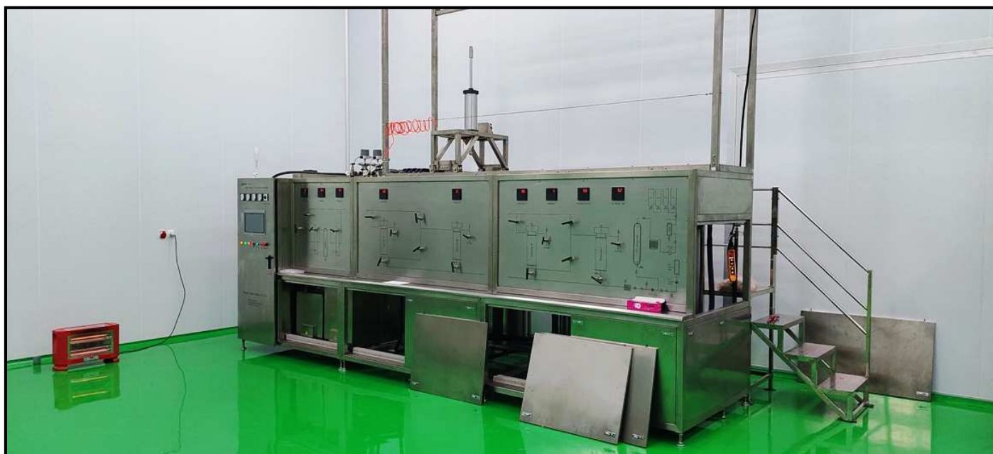
شکل ۲۰- دستگاه سیال فوق بحرانی دارای چهار مخزن استخراج هر کدام به ظرفیت ۵۰ لیتر که امکان انجام طرح‌های نیمه صنعتی را فراهم می‌آورد.
