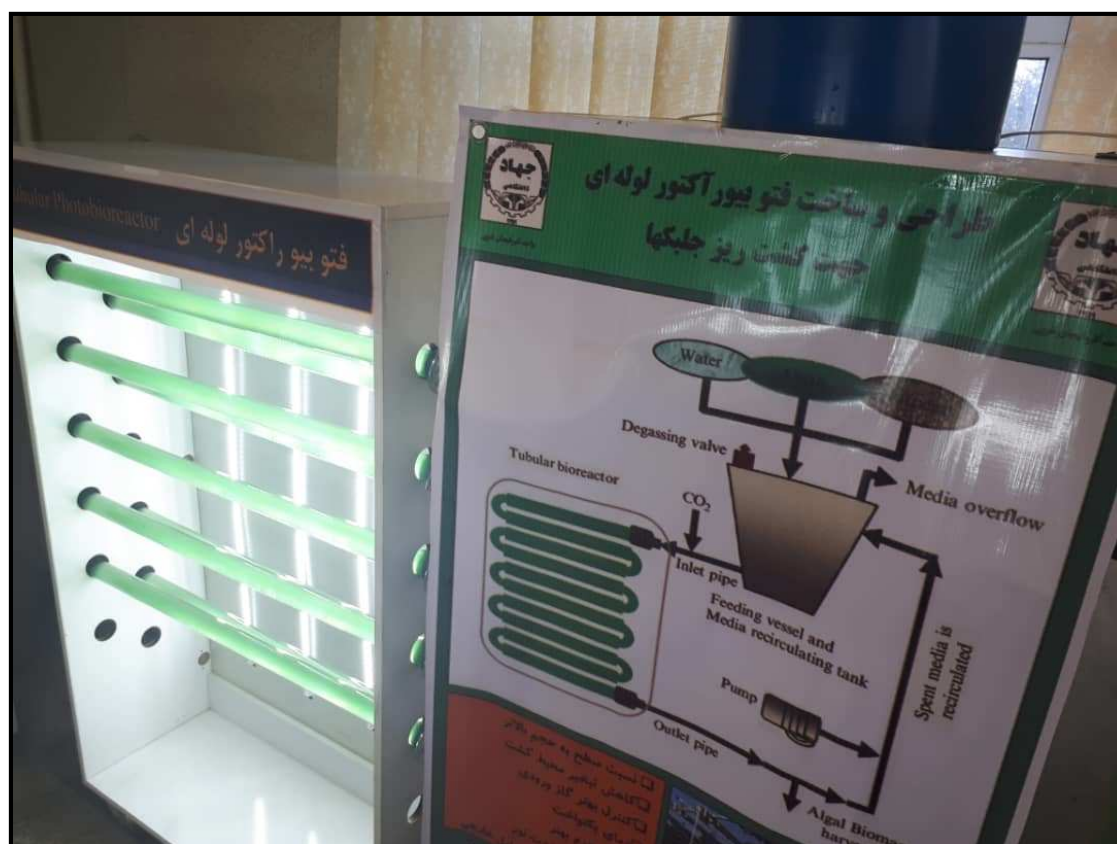
شکل ۱۰- کشت موفقیت آمیز ریزجلبک در فتوبیورآکتور لوله‌ای ساخته شده در جهاد دانشگاهی آذربایجان غربی
