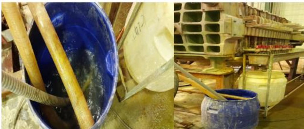
شکل ۱: تصاویری از ترسیب ناخالصی ها از محلول سولفات روی در مقیاس پایلوت
