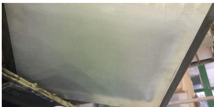
شکل ۶: روی تشکیل شده بر روی صفحات کاتد
