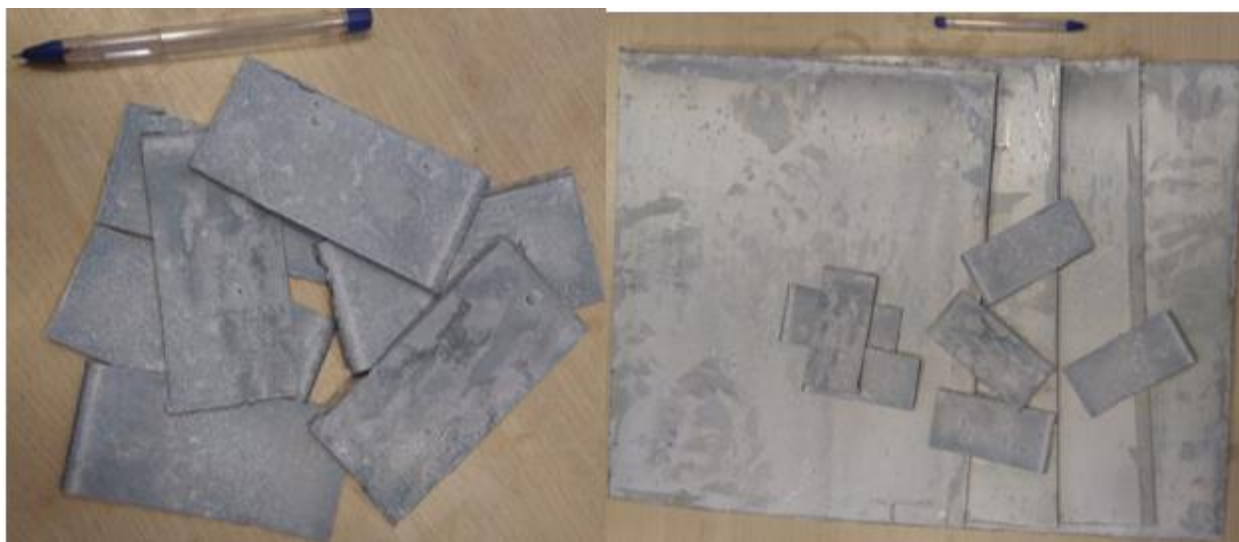
شکل ۵: روی تشکیل شده بر روی صفحات کاتد
