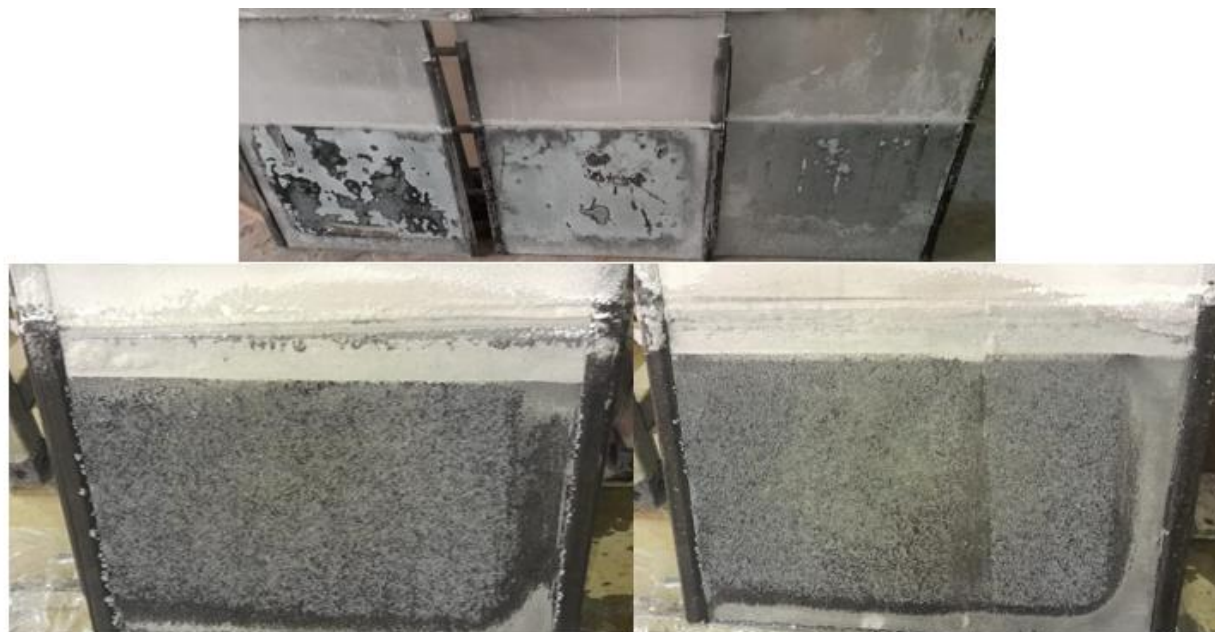
شکل ۴: رسوب روی بر روی صفحات کاتد
