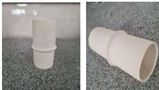
شکل ۳-۳۰- اکسترودر نمونه لوله ای شکل با استفاده از گل شماره
