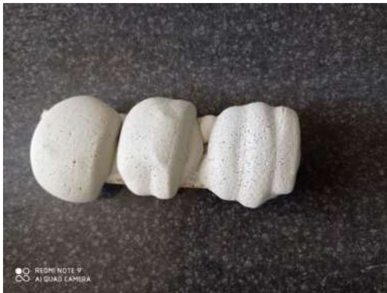
شکل ۳-۱۷- نمونه های ۷، ۸ و ۹ سینتر شده در دمای ۱۳۰۰ درجه سانتی گراد
