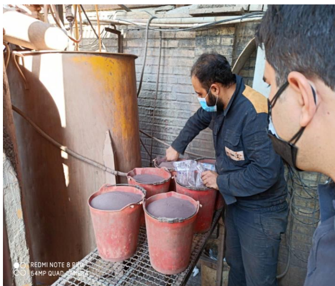
شکل ۱۱: آماده سازی خوراک برای انجام تست اسپیرال
