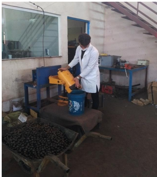
شکل ۲: نرمایش نمونه توسط آسیای میله ای
