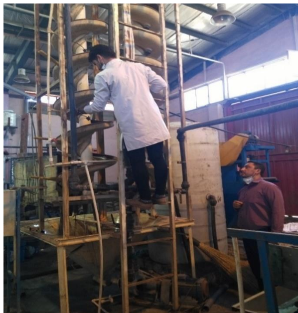
شکل ۳: سیستم جداکننده ماریچی جهت انجام تست ثقلی
