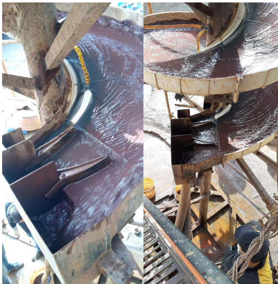
شکل ۳- جریان کنسانتره، میانی و باطله و تیغه های جداکننده روی اسپیرال
