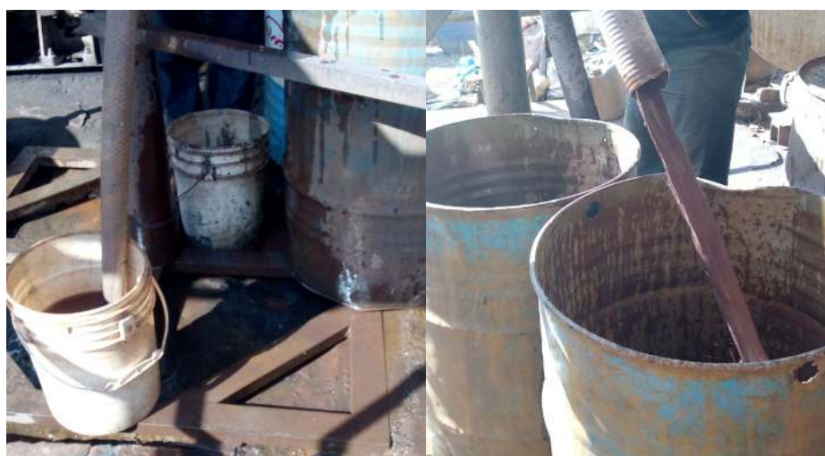
شکل ۲- محل تخلیه کنسانتره (راست) و باطله (چپ)
