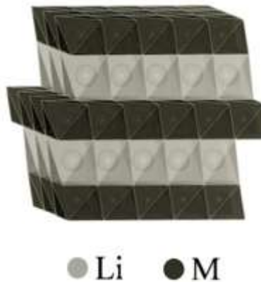
شکل ۶. شماتیک ساختار کریستالی مواد کاند \text{LiMO}_2 لایه لایه
