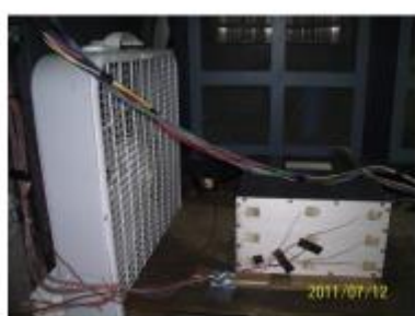
شکل ۴-۶- تست تنظیم برای شارژ سریع مدول ۲۴ ولتی
