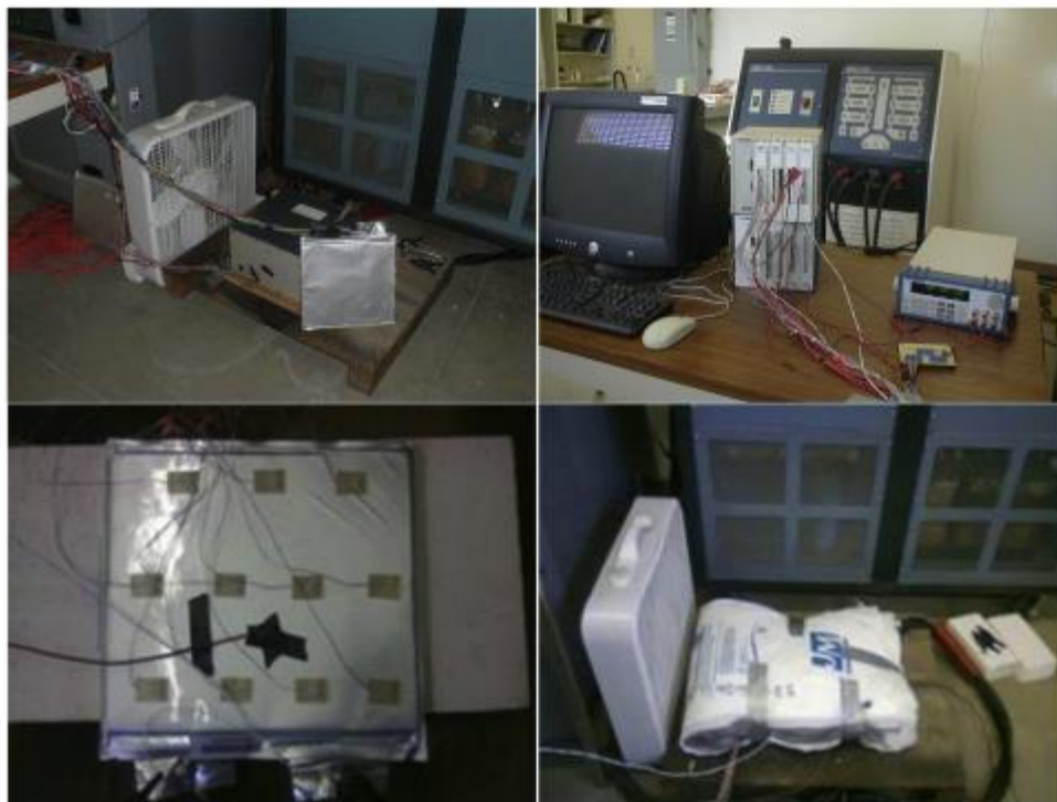
شکل ۴-۲- آزمایش سل لیتیوم تیتانیوم اکسید ۵۰-Ah
