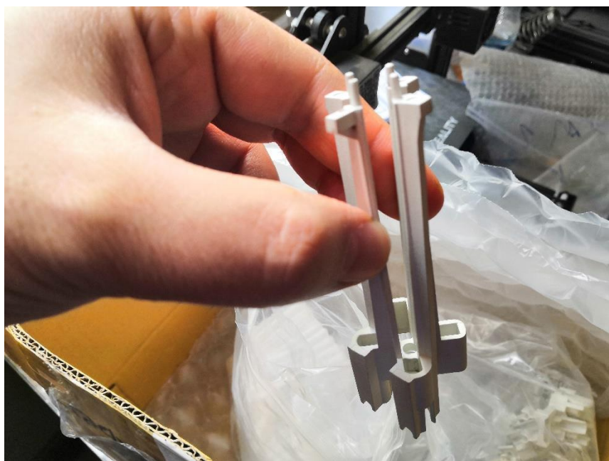
شکل ۹ رزوناتور ساخته شده به وسیله قالب
