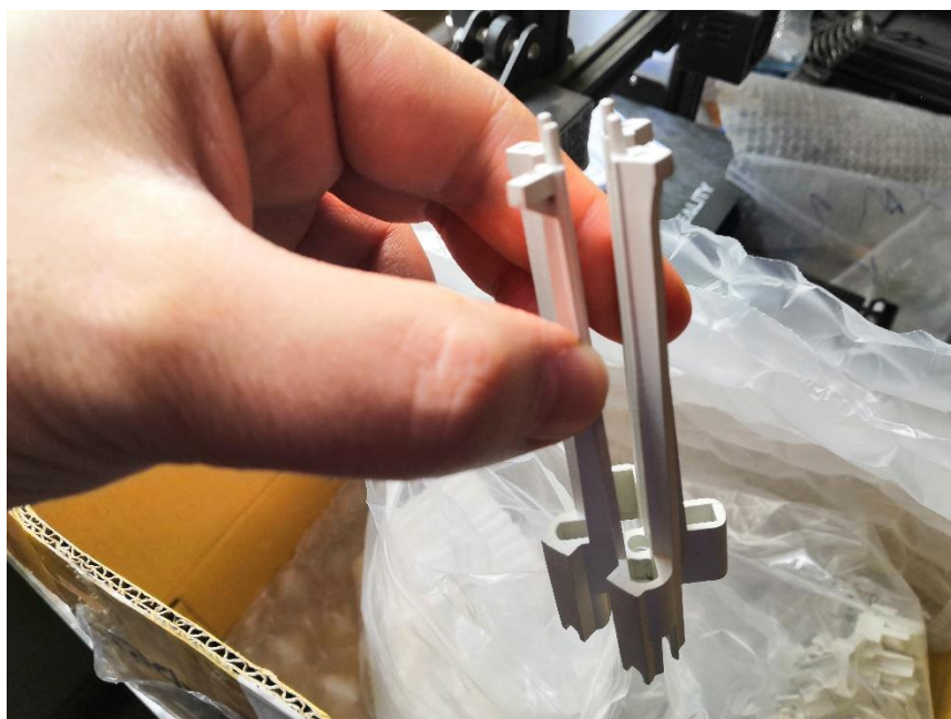
شکل ۹ رزوناتور ساخته شده به وسیله قالب
