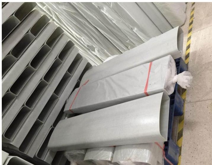
شکل ۱۲-۳. نمونه رادوم های ساخته شده توسط پیمانکار خارجی
