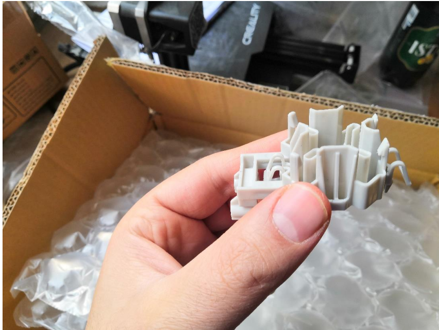
شکل ۳-۱۶. پایه پلاستیکی آنتن فرکانس پایین ساخته شده به وسیله قالب
