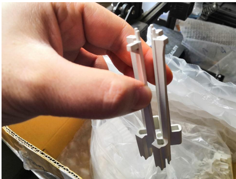
شکل ۱۶-۳. رزوناتور ساخته شده به وسیله قالب
