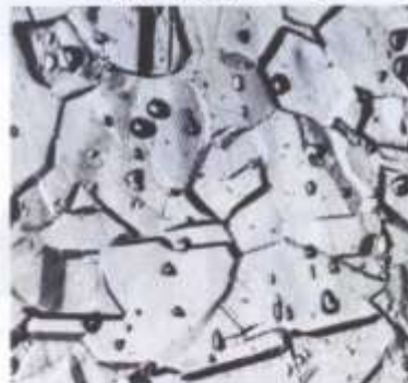
شکل ۲ - الگوی ساختار میکروسکوپی مطابق با استاندارد ASTM 262
