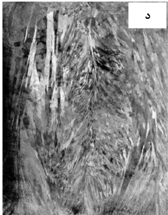
شکل ۸. تصاویر ماکروسکوپی شمش های تولید شده تحت فرایند ESR [۲۹].
