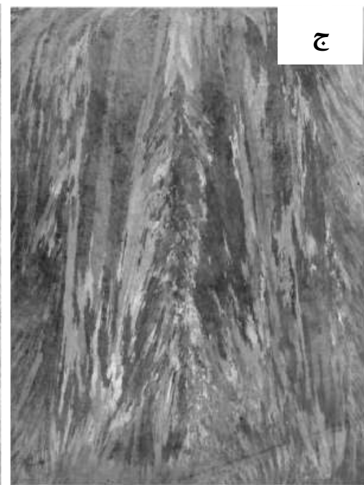
شکل ۸. تصاویر ماکروسکوپی شمش های تولید شده تحت فرایند ESR [۲۹].
