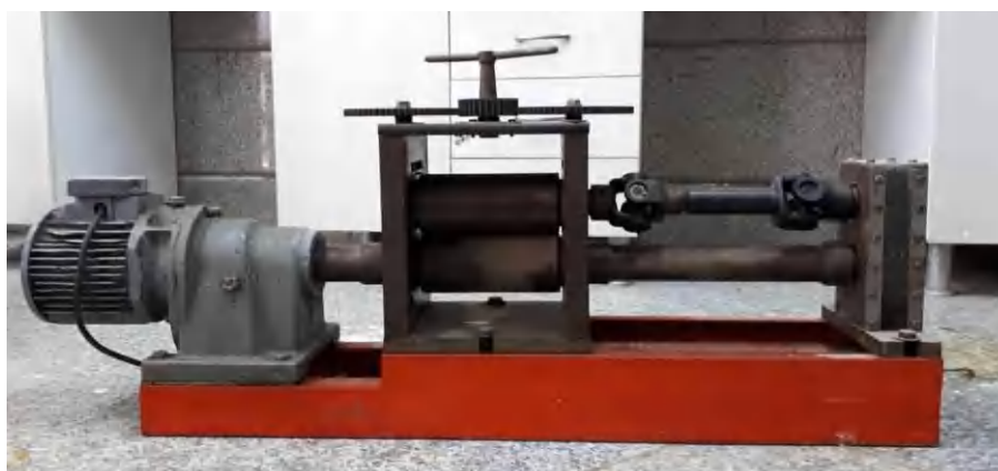
شکل ۹-۳- تصویر دستگاه نورد مورد استفاده به منظور انجام نورد در مقیاس آزمایشگاهی.
