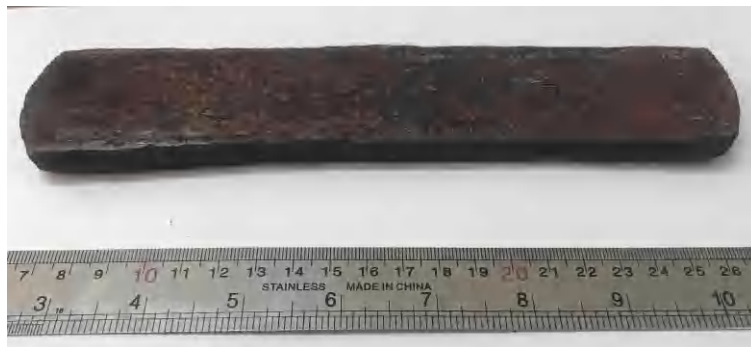
شکل ۲-۳- تصویر نمونه پس از نورد گرم.
