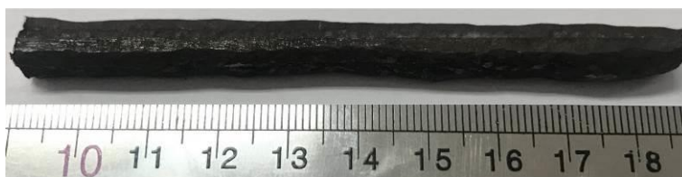
شکل ۸-۳- تصویر یکی از نمونه‌های آماده شده برای نورد سرد.
