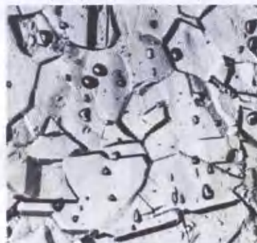
شکل ۲ - الگوی ساختار میکروسکوپی مطابق با استاندارد ASTM 262
