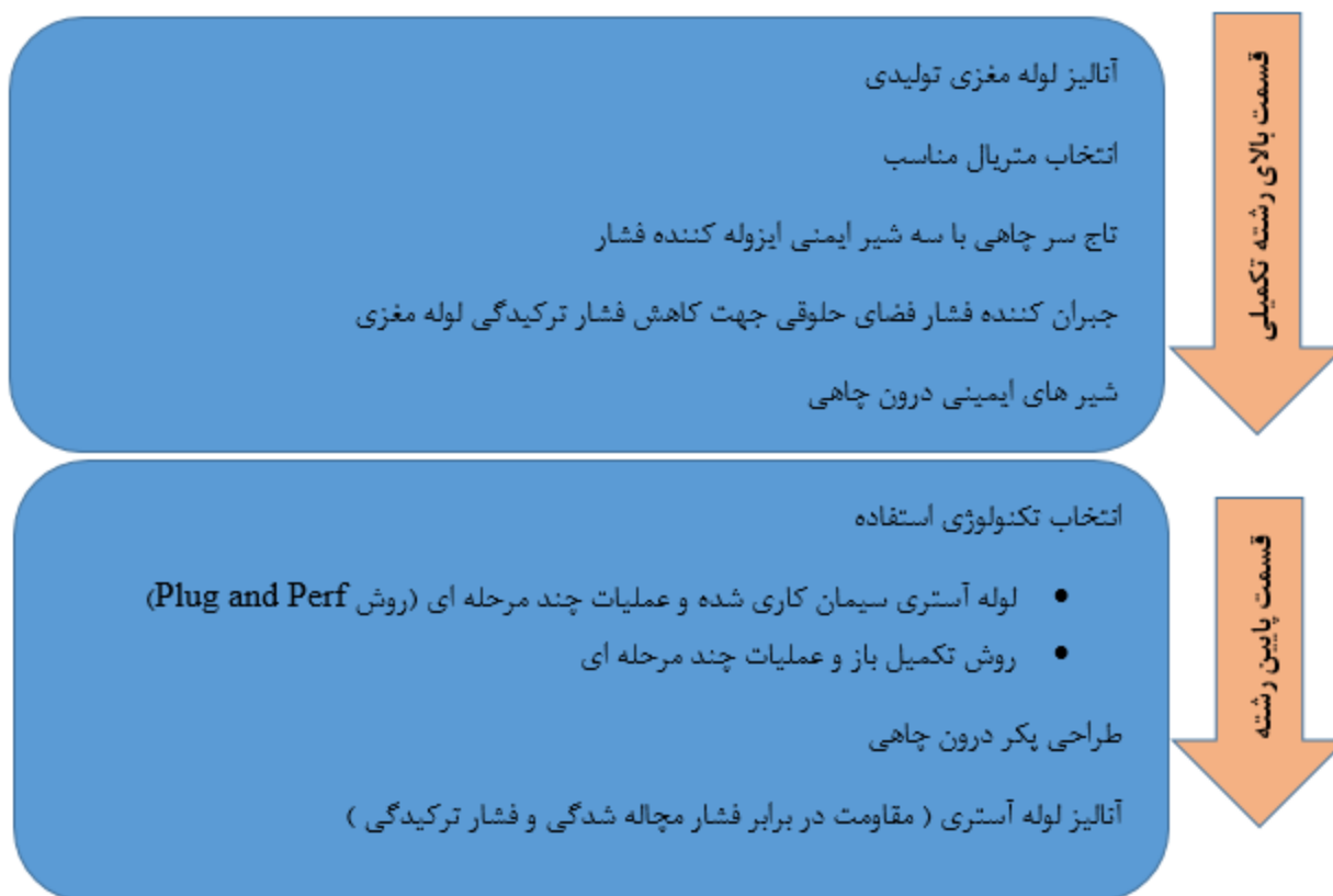
شکل ۴-۱۱: ملاحظات مورد نیاز در طراحی رشته تکمیلی عملیات شکافت هیدرولیکی
