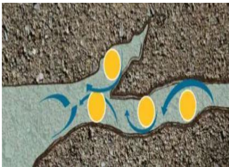
شکل ۴-۲: شیوه نگه داشت شکاف به وسیله ی پروپانت (Zendehboudi and Bahadori, 2017)
