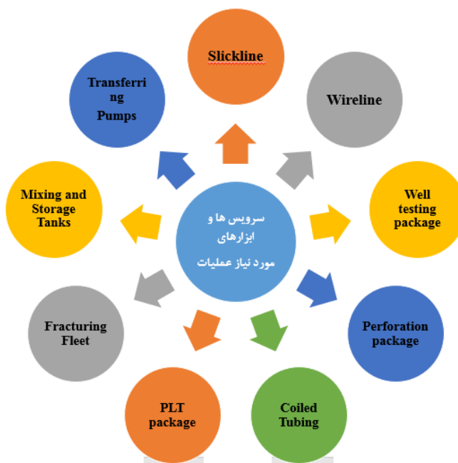
شکل ۴-۱۵: سرویس ها و نیازمندیهای عملیات شکافت هیدرولیکی را نشان می دهد.
