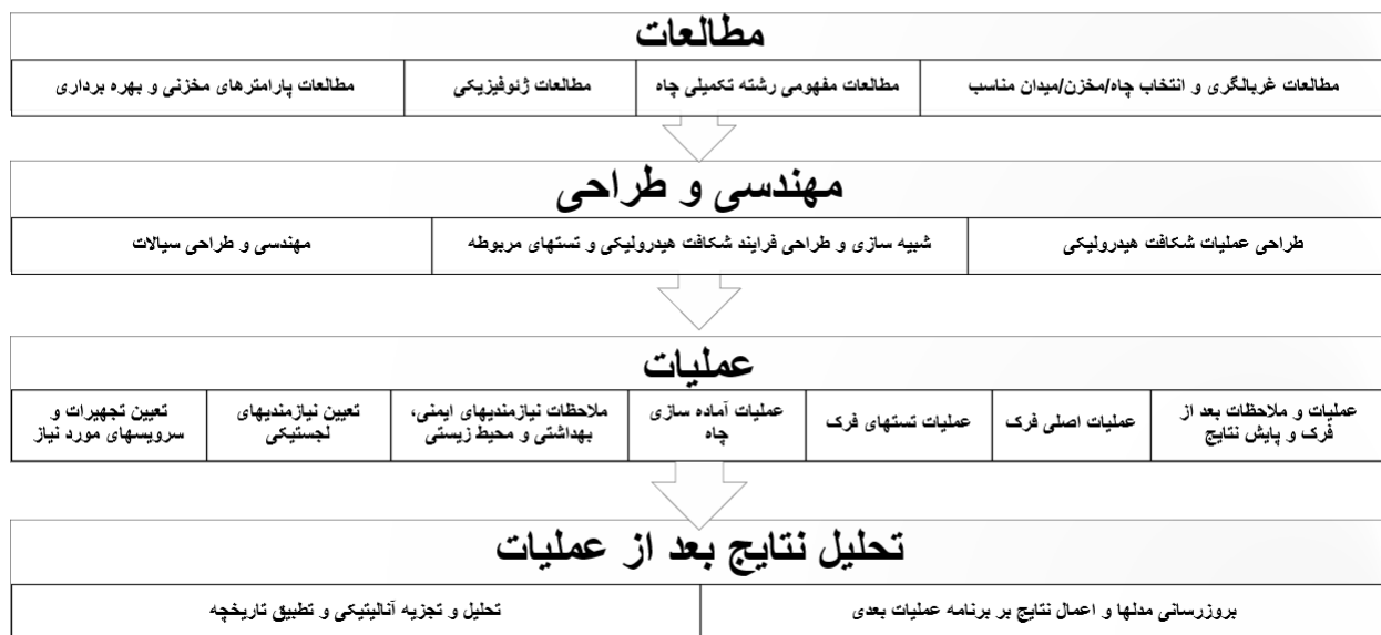
شکل ۱: فرایند طراحی جامع شکاف هیدرولیکی
