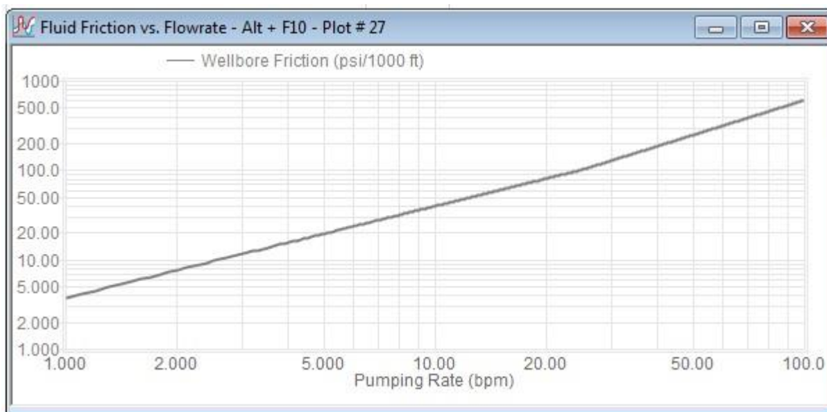
شکل ۳-۵: فشار اصطکاکی سیال PAD با نرخ های مختلف تزریق
