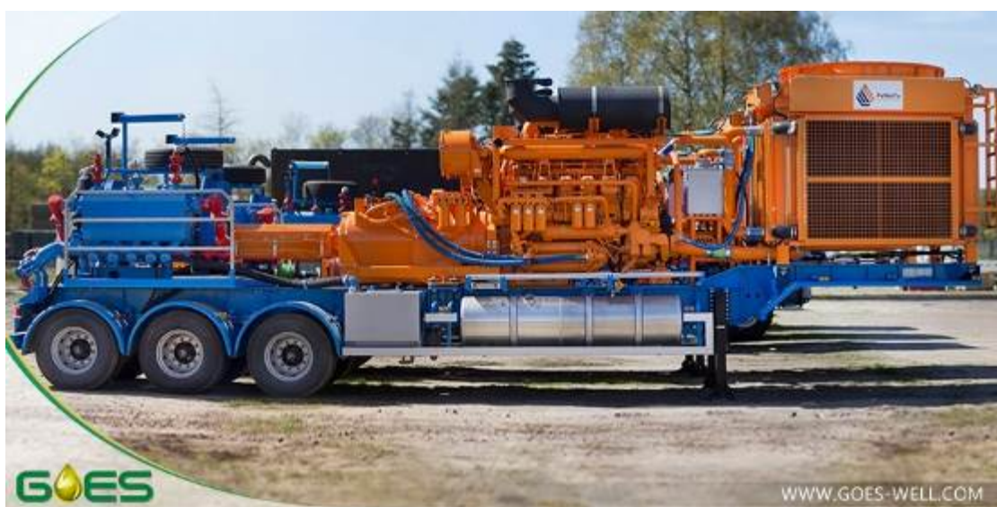
شکل ۶-۱۷- نمونه پمپهای فشار بالا، مورد استفاده در عملیات شکافت هیدرولیکی ( https://www.global.weir )
