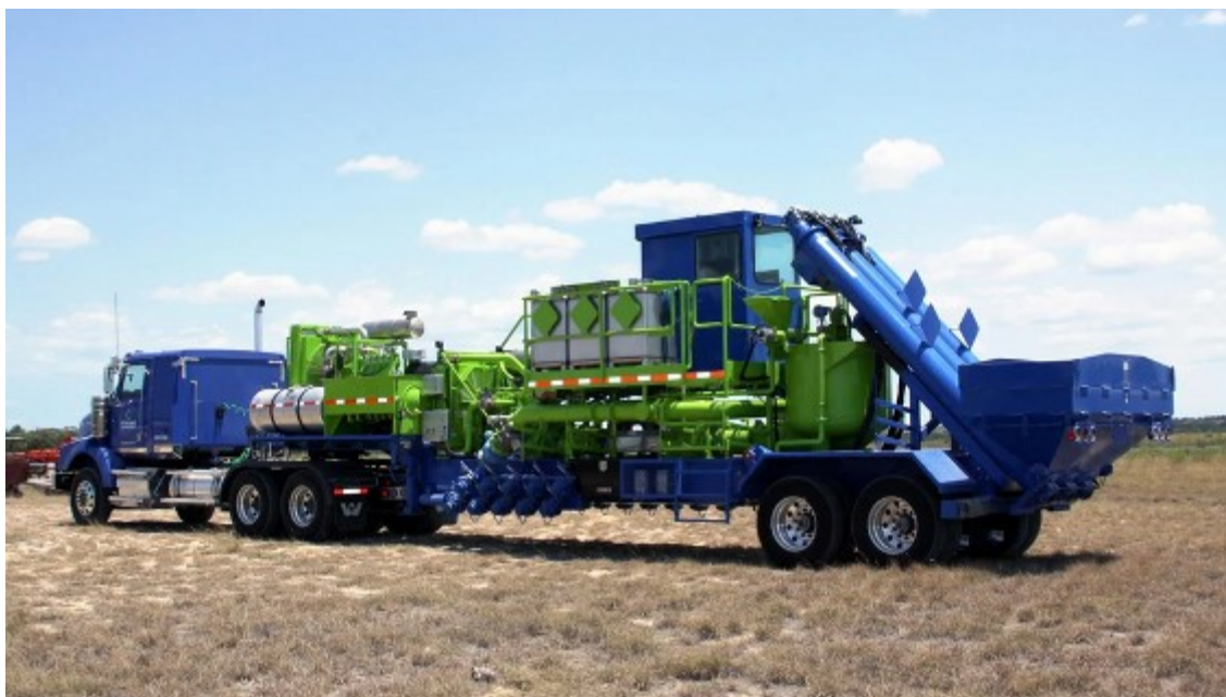
شکل ۶-۱۸- مخلوط کن مورد استفاده در عملیات شکافت هیدرولیکی ( https://www.nov.com/products/frac-blenders )
