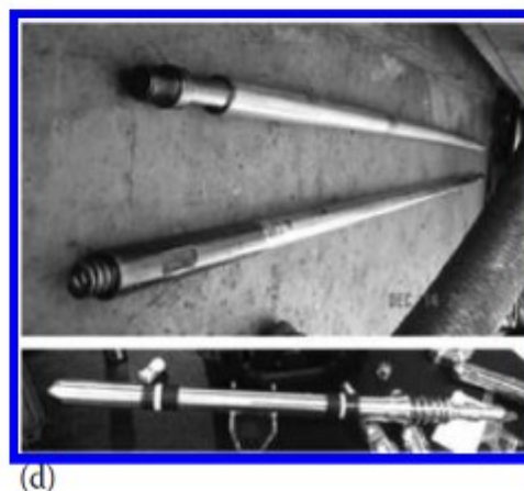
شکل ۶-۲۷- الف) چگالی سنج رادیواکتیو ب) جریان سنج فشار بالا پ) گیرنده ی فشار ت) گیج فشار ته چاهی
