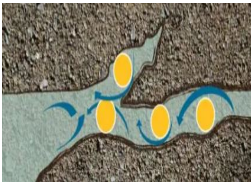
شکل ۲-۲- باز نگه داشتن شکاف به وسیله ی پروپانت (Zendehboudi and Bahadori, 2017)
