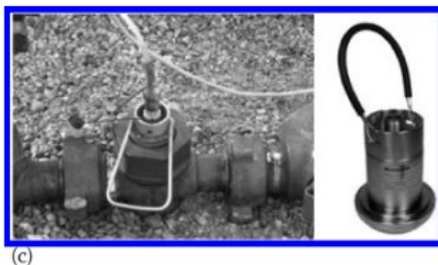
شکل ۶-۲۷- الف) چگالی سنج رادیواکتیو ب) جریان سنج فشار بالا پ) گیرنده ی فشار ت) گیج فشار ته چاهی
