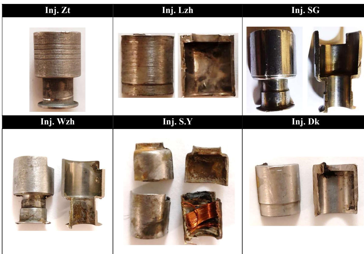
شکل ۱-۲۴: تصویر پوسته سیم پیچ برای شش انژکتور مورد مطالعه
