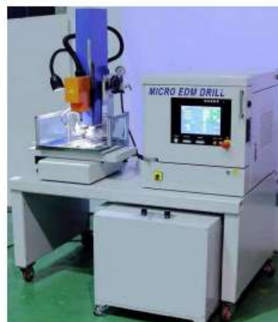
شکل ۱-۱۶: دو نمونه دستگاه EDM برای سوراخکاری صفحه پاشش
