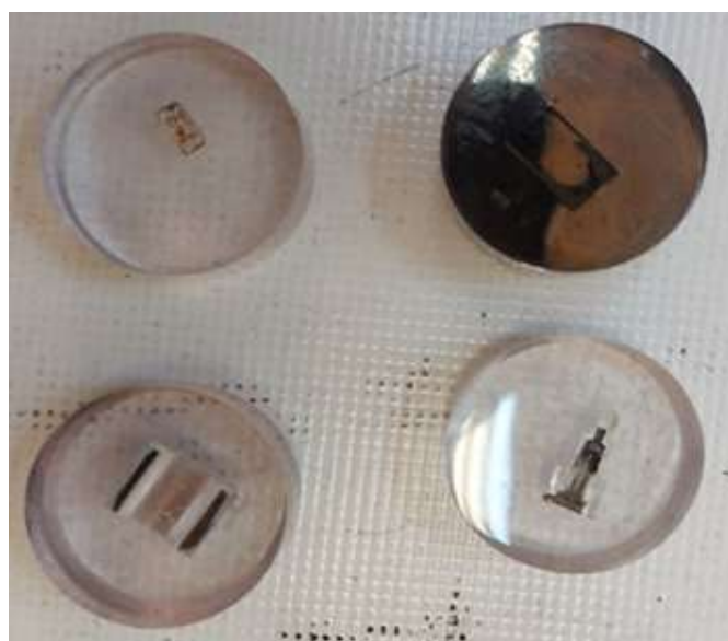
شکل ۲-۴: نمونه های مانت شده جهت اندازه گیری با استفاده از دستگاه استریوسکوپ
