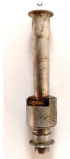
شکل ۲-۵: تصویر اندازه گیری انژکتورهای مورد مطالعه پیش از دمونتاز و برش
