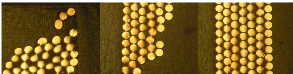
شکل ۳-۸: تصاویر دو انتها و قسمت میانی مقطع موازی با محور طولی سیم پیچ
