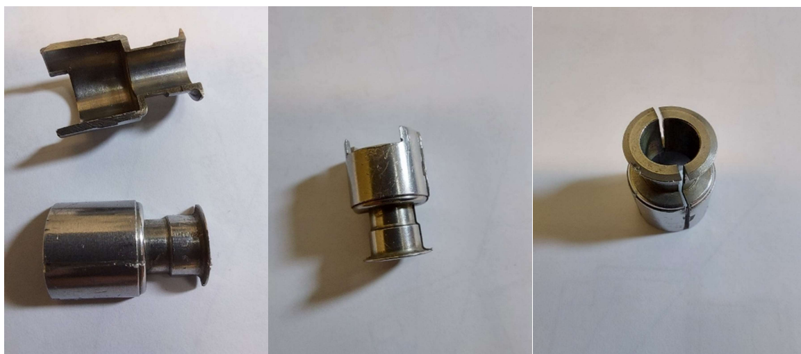
شکل ۱-۳: عکس برش خورده از پوسته سیم پیچ در نماهای مختلف
