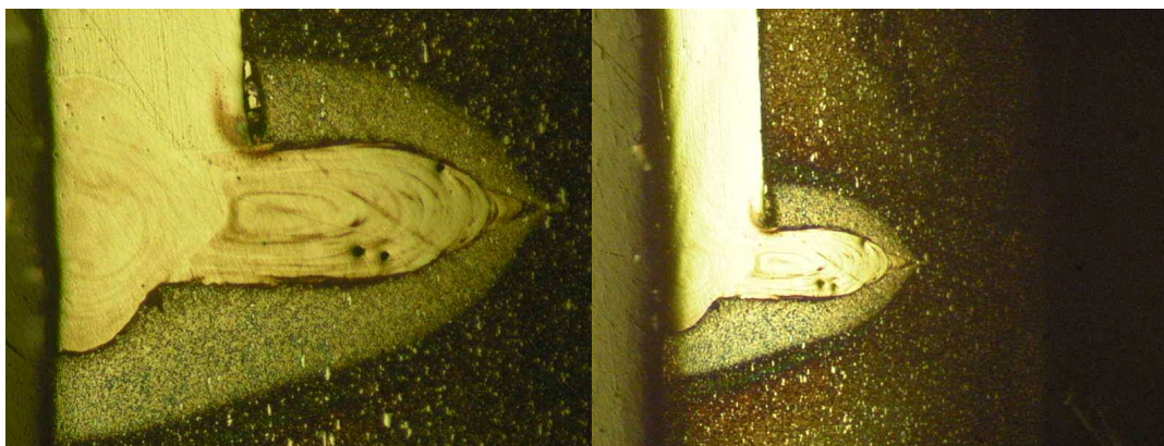
شکل ۳-۳: تصاویر جوش محفظه به لوله اصلی در بزرگنمایی های ۲۵ و ۵۰ برابر
