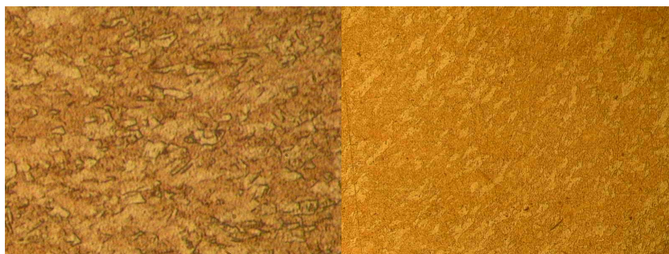
شکل ۳-۱۰: تصاویر ریز ساختار ترمینال در بزرگنمایی‌های ۱۰۰ و ۲۵۰ برابر
