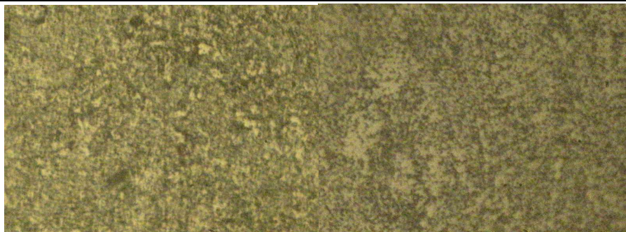
شکل ۳-۲۳: تصاویر ریز ساختار فتر در بزرگنمایی های ۵۰۰ و ۱۰۰۰ برابر
