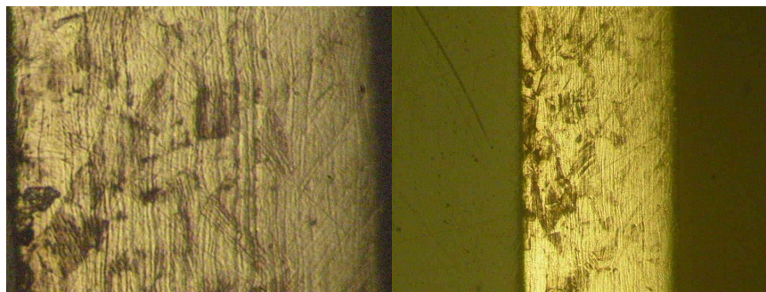
شکل ۳-۲۷: تصاویر ریزساختار صفحه پاشش در بزرگنمایی‌های ۱۰۰ و ۲۵۰ برابر
