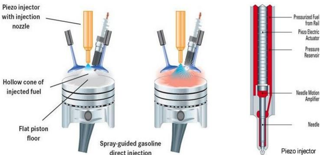
شکل ۲-۱۲: تکنولوژی تزریق مستقیم با هدایت اسپری توسط انژکتور پیزوالکتریک
