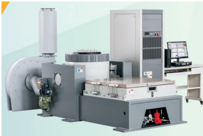
شکل ۴-۱۶: تجهیز تست ارتعاش تولیدی شرکت آزمون سنجش، مدل SVS-2200
