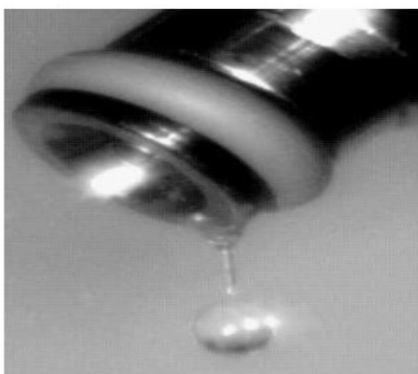
شکل ۱-۶: ریزش سوخت انباشته شده از نوک انژکتور
