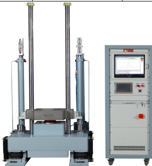
شکل ۴-۱۷: تجهیز تست شوک مکانیکی نیم سینوسی شرکت Labtone مدل SKT100 ساخت چین
