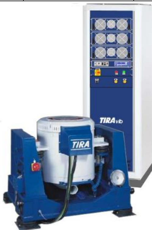
شکل ۴-۱۵: تجهیز تست ارتعاش شرکت TIRA vib مدل TV 56280/LS-340 ساخت آلمان
