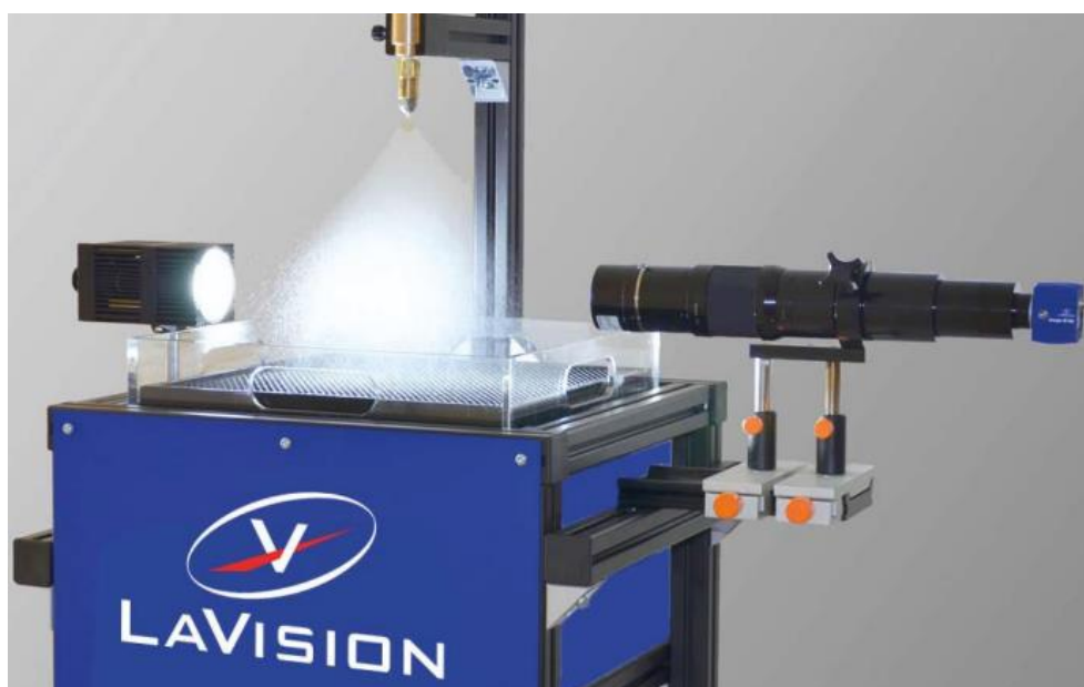
شکل ۷-۴: تجهیز تست Lavisions Spray Master inspex system، برای تست مشخصات اسپری ساخت آلمان
