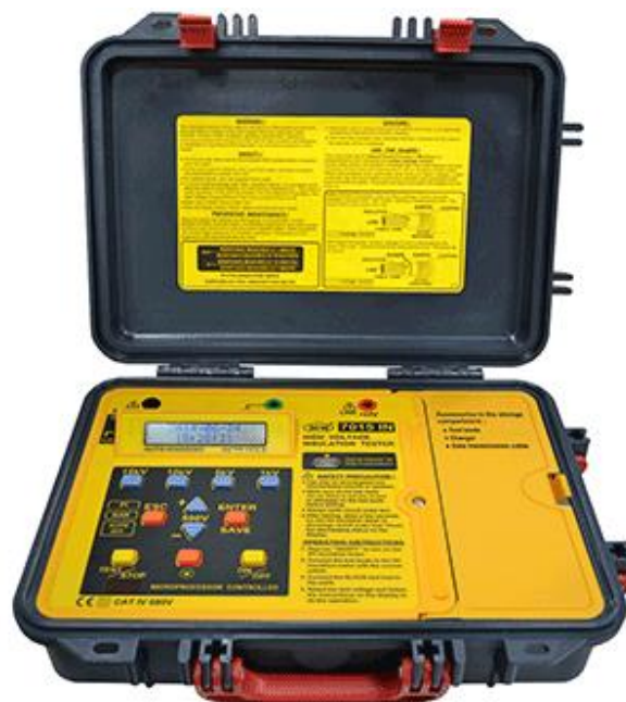
شکل ۴-۲: تجهیز تست تعیین مقاومت عایق، میگر دیجیتال ۱۵۰۰۰ ولت شرکت SEW مدل 7016 IN ساخت تایوان
