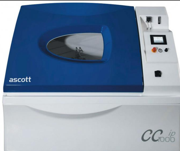
شکل ۴-۱۰: تجهیز تست خوردگی شرکت Ascott مدل CC450iP
