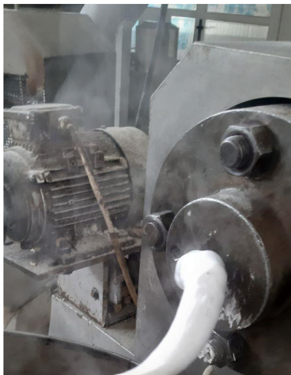
دستگاه در حال شروع فرایند اکستروژن نشاسته
