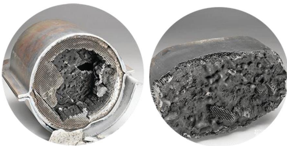
شکل ۵- مبدل کاتالیستی مستعمل. به بسته شدن منافذ عبور گاز توجه شود.
