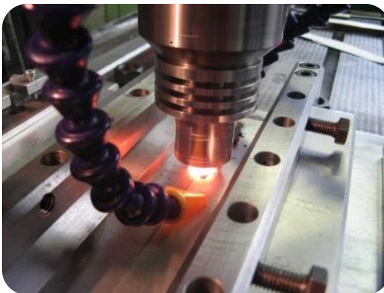
شکل ۷- جوشکاری اصطکاکی- اغتشاشی
