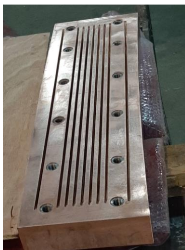
شکل ۱۱- صفحه کوچک کریستالیزاتور ماشینکاری نهایی شده
