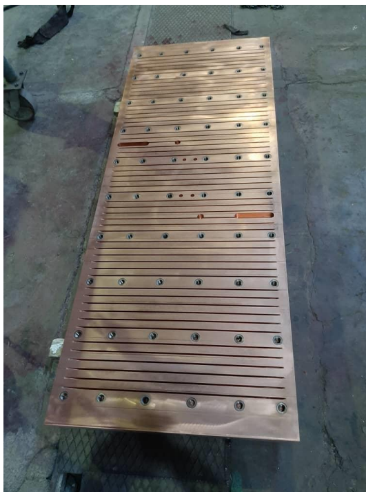
شکل ۱۰- صفحه بزرگ کریستالیزاتور ماشینکاری نهایی شده
