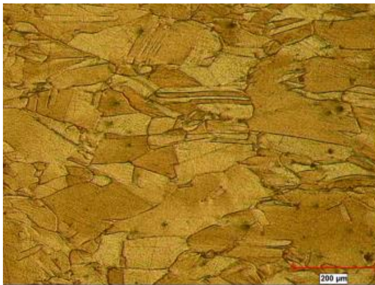
شکل ۲- ریزساختار نمونه در جهت عمود بر نورد بزرگنمایی ۵۰ X
