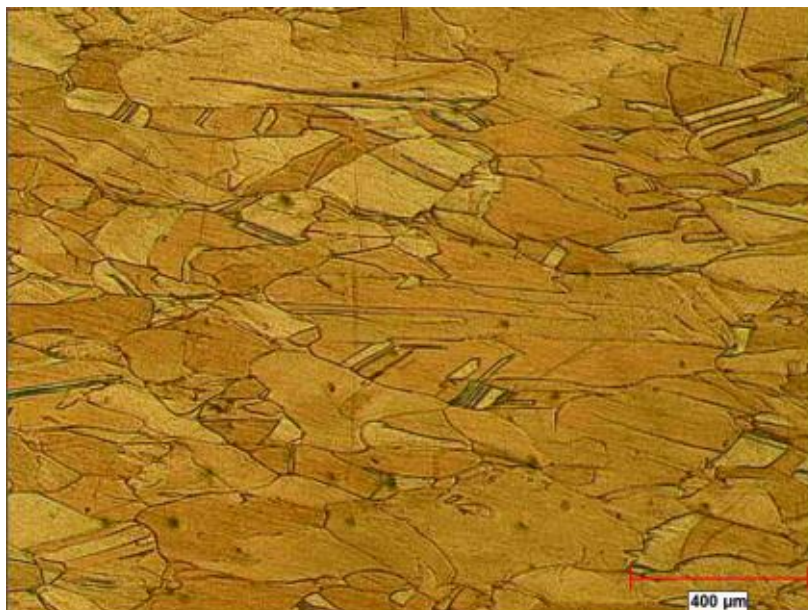
شکل ۱- ریزساختار نمونه در راستای نورد بزرگنمایی ۲۵ X
