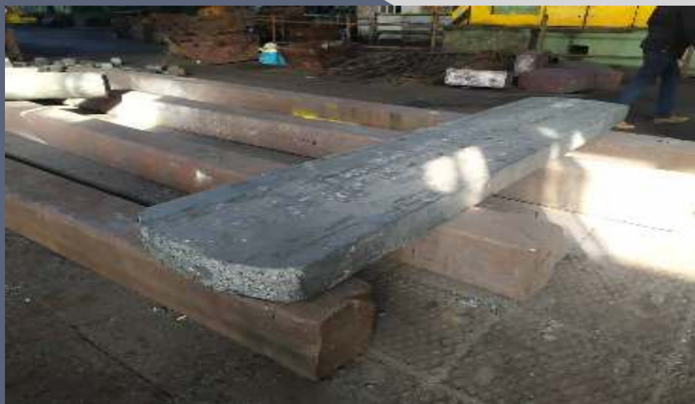
شکل ۸- صفحه مسی به دست آمده بعد از فورج گرم با ابعاد: ۱۴۰*۷۲۰ ۳۶۰۰ میلیمتر
