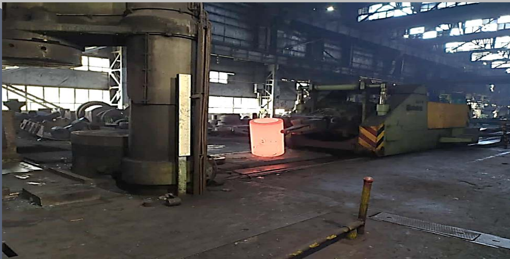
شکل ۲- پیشگرم شمش به قطر ۶۵۰ میلیمتر و طول ۱۱۰۰ میلیمتر، آماده برای عملیات فورج گرم
