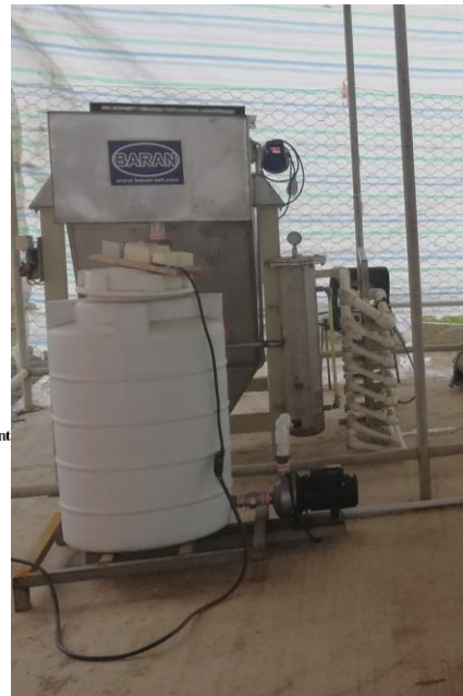
شکل ۳: شماتیک و تصویر فرآیند تصفیه به روش شناورسازی با هوای فشرده
