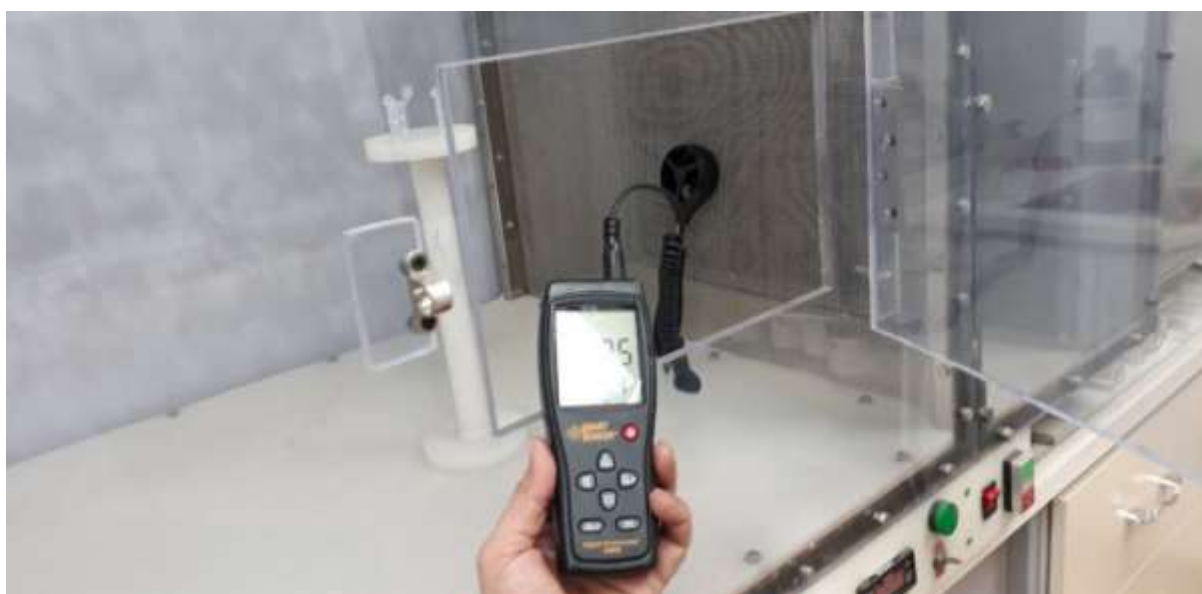
شکل ۳-۱۱ دستگاه تعیین سرعت باد و رطوبت سنج در تستهای تونل باد
