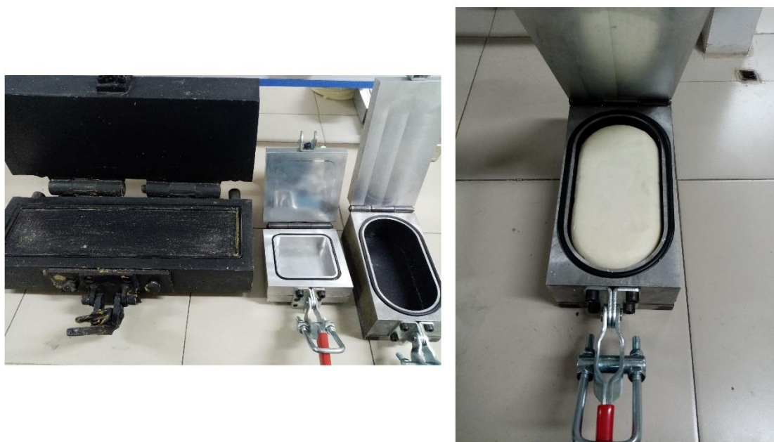
شکل ۴-۸. (سمت چپ) قالب های در بسته مختلف مورد استفاده به ترتیب از چپ به راست: قالب مستطیلی بزرگ با ضخامت نهایی، قالب مستطیلی کوچک با ابعاد نهایی، قالب بیضوی با ضخامت بیشتر از محصول نهایی.
