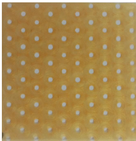
شکل ۴-۹. طرح شابلون مورد استفاده برای پوشش‌دهی سیلیکون بر روی فوم.
