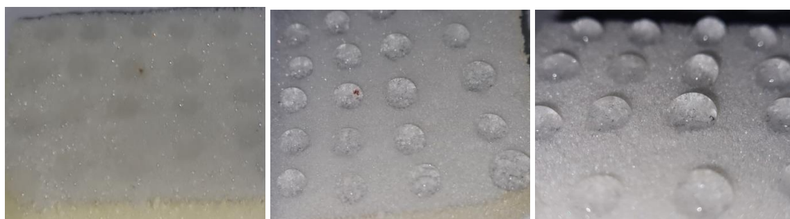
شکل ۶. بررسی خاصیت نرخ جذب آب بر سطح زخم پوش فوم
