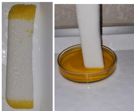
شکل ۸. انجام آزمون خاصیت موینگی نمونه‌ی زخم پوش هایدروفایبر
