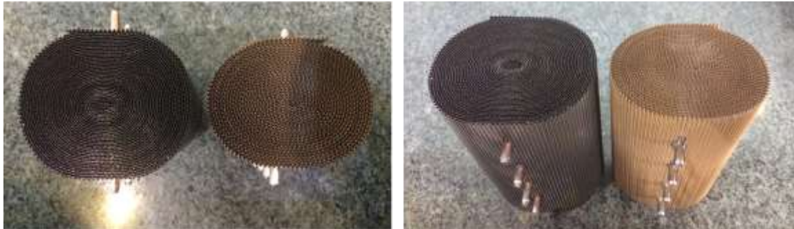
شکل ۲-۴۲- تصویر نمونه مونولیت خام تولید شده در کنار نمونه مرجع از دو نمای مختلف.
