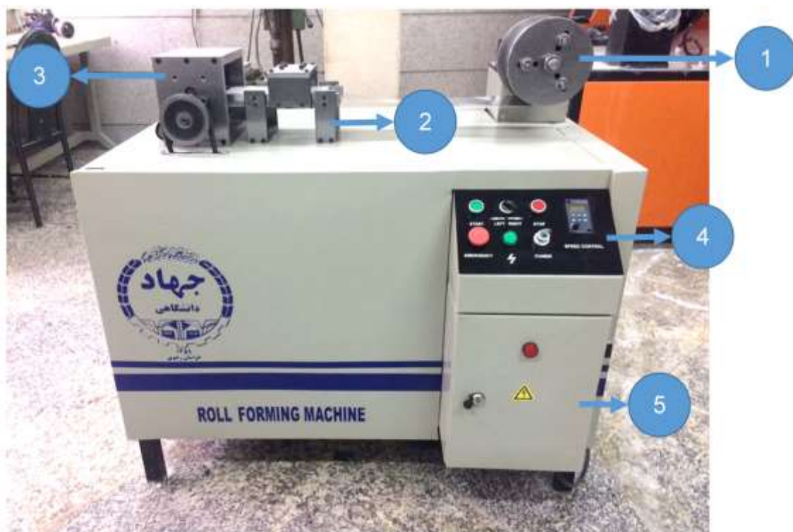
شکل ۲-۲۳: بخش‌های مختلف دستگاه فرم‌دهی طراحی و ساخته شده.
