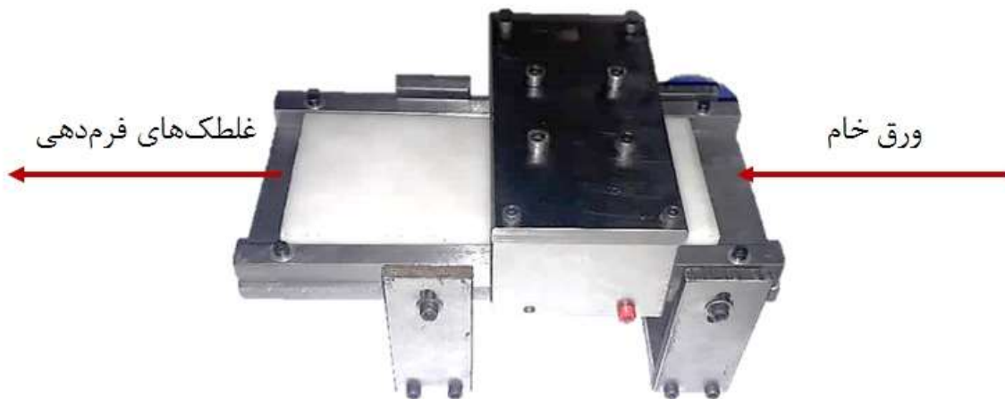
شکل ۲-۲۰- تصویر از قسمت راهنما که بر روی دستگاه نصب خواهد شد.
