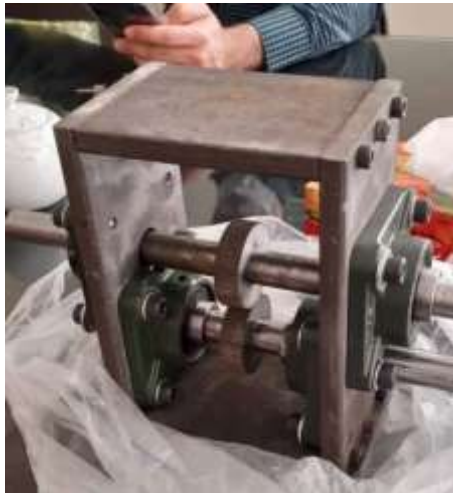
شکل ۲-۱۸- تصویری از دستگاه شکل‌دهی آزمایشی اولیه برای کرکره‌ای کردن ورق.
