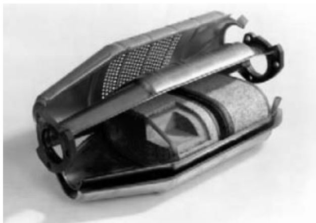
شکل ۲-۴: نمونه‌ای از مبدل‌های کاتالیستی مونولیتی اولیه
