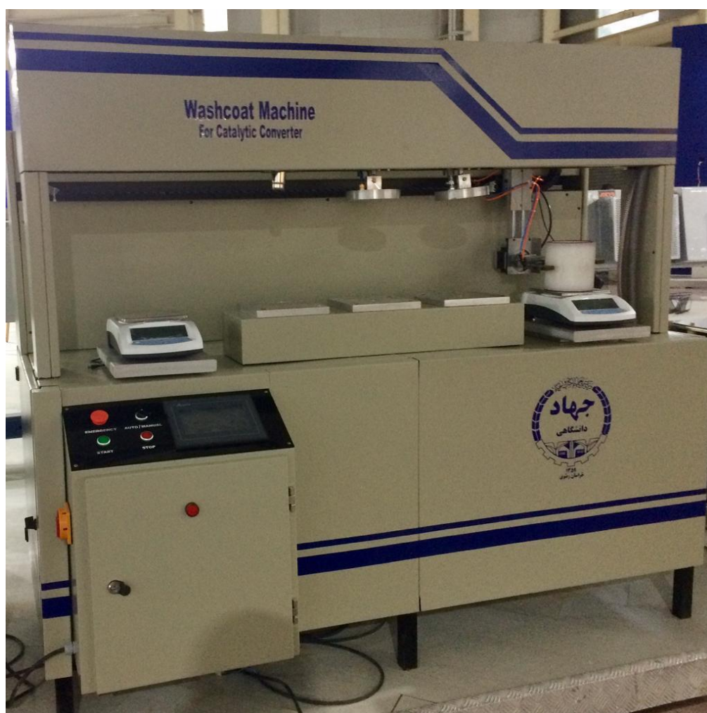
شکل ۳-۲۳: تصویر دستگاه طراحی و ساخته شده به منظور واش کوت مونولیت.
