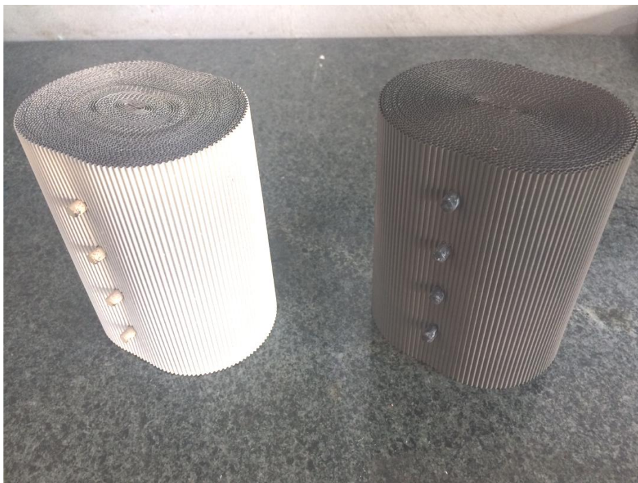
شکل ۳-۲۴: تصویر مونولیت فلزی بدون پوشش (سمت راست) در کنار مونولیت فلزی پوشش داده شده (سمت چپ).
