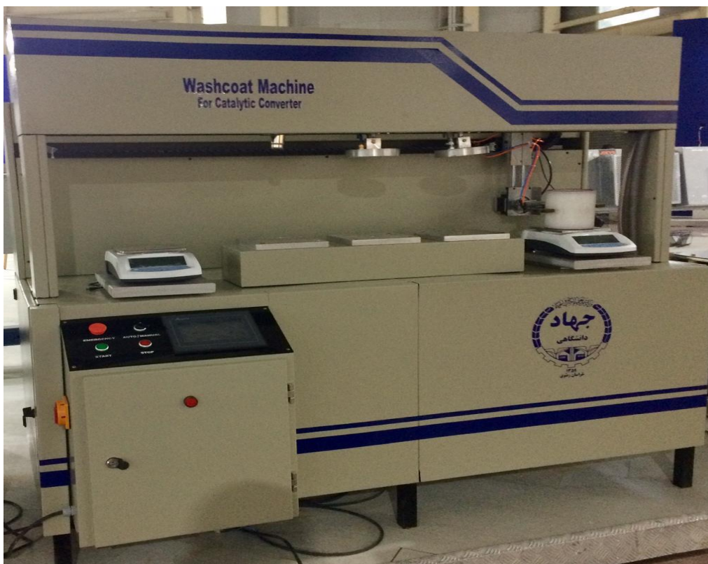
شکل ۲- دستگاه پوشش‌دهی به کمک خلا برای اعمال پوشش بر روی مونولیت فلزی.
