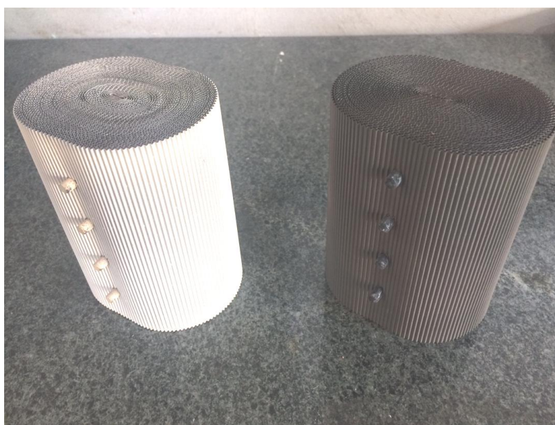
شکل ۳-۲۵: تصویر مونولیت فلزی بدون پوشش (سمت راست) در کنار مونولیت فلزی پوشش داده شده (سمت چپ).
