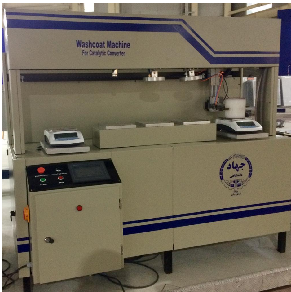
شکل ۳-۲۴: تصویر دستگاه طراحی و ساخته شده به منظور واش کوت مونولیت.
