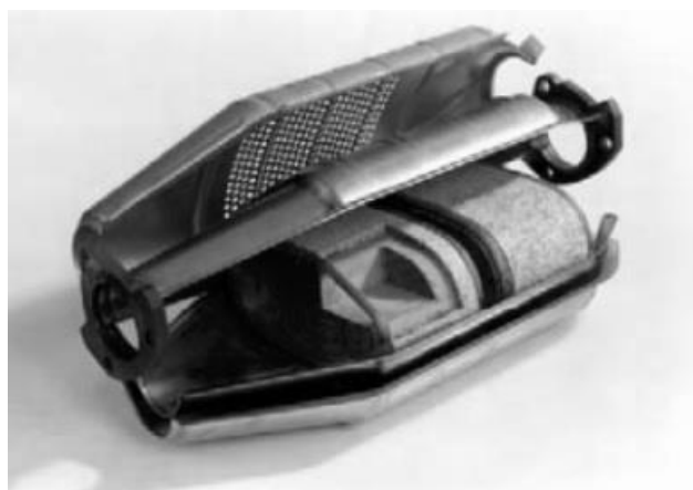
شکل ۲-۴: نمونه‌ای از مبدل‌های کاتالیستی مونولیتی اولیه.
